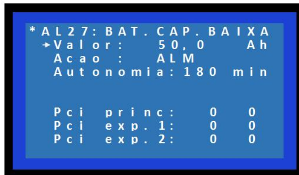
Figura 14 - Alarmes - Teste de Baterias
