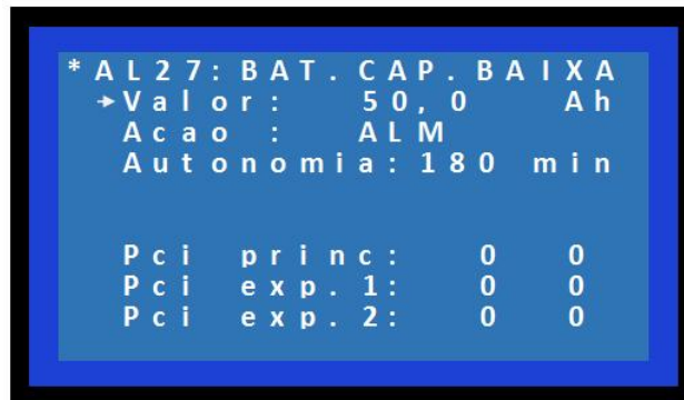
Figura 21 - Alarmes - Teste de Baterias
