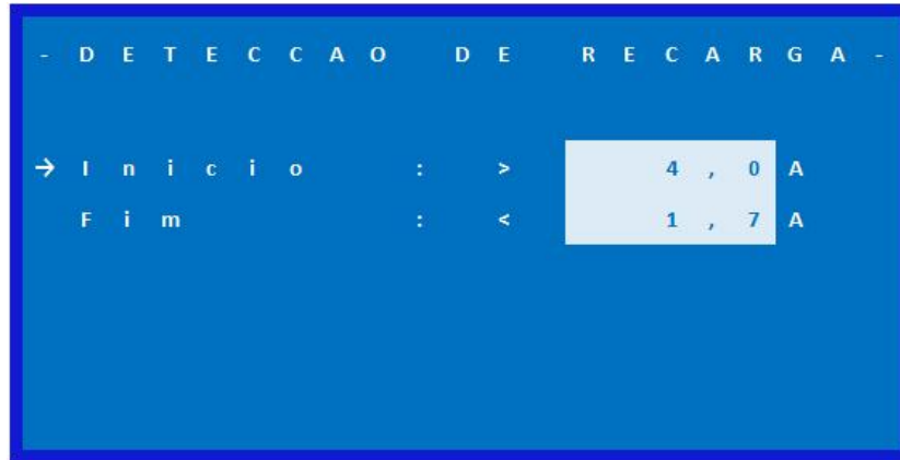
Figura 38 - Detecção de Recarga
