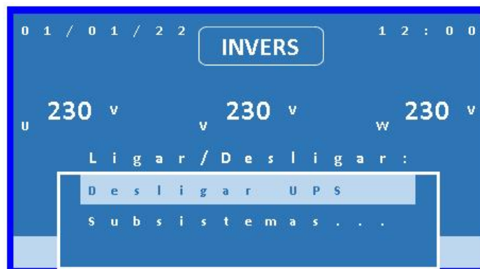
Figura 7 - Desligar equipamento pelo Pop-Up Ligar/Desligar
